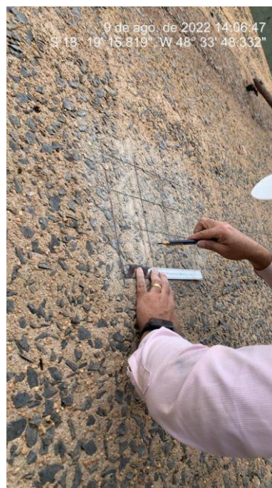
Foto 28 - Realização de ensaios de esclerometria e avaliação visual da superfície da Superestrutura
