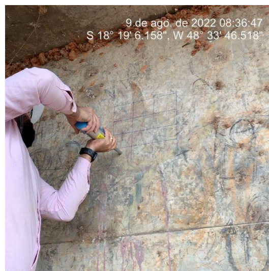
Foto 26 - Realização de ensaios de esclerometria e avaliação visual da superfície da Superestrutura
