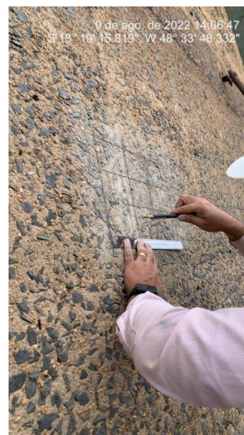
Foto 24 - Realização de ensaios de esclerometria e avaliação visual da superfície da Mesoestrutura
