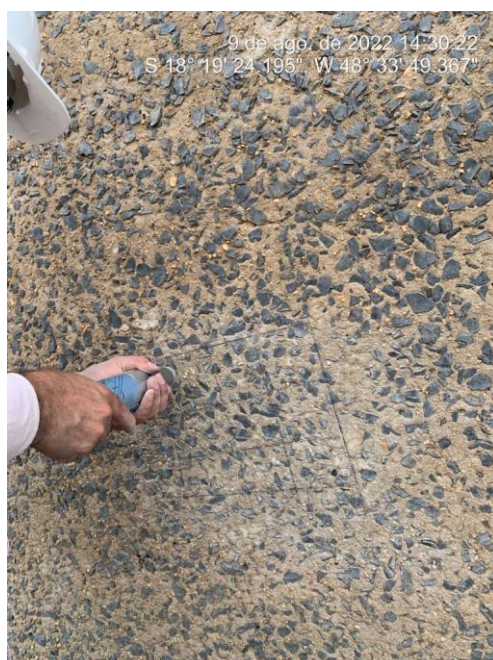
Foto 29 – Realização de ensaios de esclerometria e avaliação visual da superfície da Mesoestrutura
