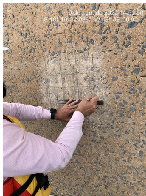
Foto 30 - Realização de ensaios de esclerometria e avaliação visual da superfície da Superestrutura
